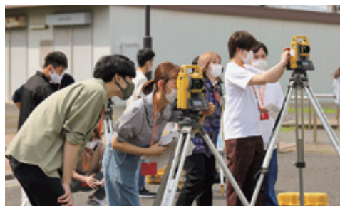
1年生「測量実習Ⅰ」で実施したTS（トータルステーション）の据付と測距・測角（船橋キャンパス）
